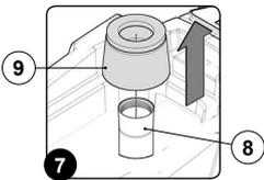
Para limpiar el filtro-flotador del tanque de recuperación con la pistola de rociado, sólo para las versiones con el sistema SST, ejecutar las siguientes operaciones:
