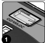
En el panel de mando de la máquina hay una pantalla del contador de horas (1) que permite observar el tiempo total de uso (Fig. 1). Las cifras antes del símbolo "." identifican las horas, mientras que la cifra que lo sigue identifica los decimales de hora (un decimal de hora corresponde a seis minutos). Cuando parpadea el símbolo "." significa que el contador de horas está contando el tiempo de funcionamiento de la máquina.
