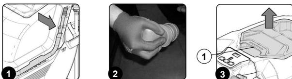
6. Con el tanque de recuperación de vacío, girar el soporte de la tapa del tanque de recuperación (2); el soporte opcional está situado en la parte lateral izquierda de la máquina (Fig. 4).
