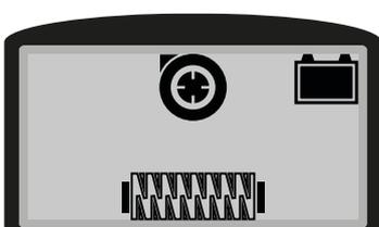
L'immagine qui a fianco identifica la schermata lavoro "LAVAGGIO CON ASCIUGATURA IN MODALITÀ ECO-MODE" versioni BTS. Il simbolo che compare al centro dello schermo serve per identificare la tipologia di lavoro che si sta effettuando. In questo caso sia il corpo basamento che il corpo tergipavimento sono a contatto con il pavimento. Il programma di lavoro selezionato è quello eco-mode.
