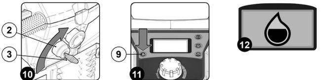
15. Dopo avere eseguito la regolazione della quantità di acqua presente nel circuito di dosaggio, premere il pulsante (10) inerente alla regolazione della percentuale detergente erogata dal sistema di dosaggio (Fig.13).
