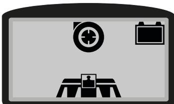
L'immagine qui a fianco identifica la schermata lavoro "LAVAGGIO CON ASCIUGATURA CON EXTRA PRESSIONE" versioni con sistema PM. Il simbolo che compare al centro dello schermo serve per identificare la tipologia di lavoro che si sta effettuando. In questo caso sia il corpo basamento che il corpo tergipavimento sono a contatto con il pavimento. Sul corpo basamento si sta esercitando l'extra pressione.
