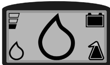
L'immagine qui a fianco identifica la "QUANTITÀ ACQUA A ZERO" nel circuito impianto idrico (versioni con sistema CDS). Il simbolo che compare al centro dello schermo serve per identificare che in quel momento la quantità di acqua nell'impianto idrico dell'apparecchio è pari a zero.
