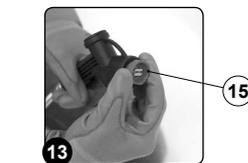
12. Pulire sotto un getto d'acqua la spazzola e rimuovere eventuali impurità presenti nelle setole. Verificare l'usura delle setole e in caso di consumo eccessivo sostituire la spazzola (la sporgenza delle setole non deve essere inferiore a 10 mm).
