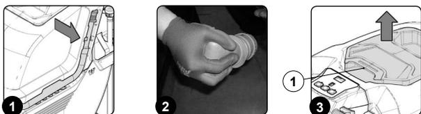
6. A serbatoio di recupero vuoto, ruotare il supporto coperchio serbatoio di recupero (2), il supporto opzionale è posizionato nella parte laterale sinistra dell'apparecchio (Fig.4).
