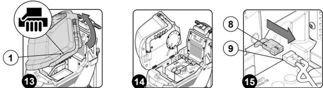
16. Fare presa sulla maniglia (1) posizionata nella parte laterale del serbatoio di recupero (Fig.16).
