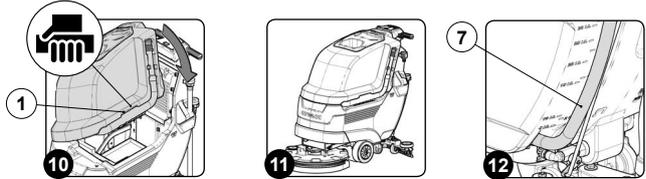
14. Fare presa sulla maniglia (1) posizionata nella parte laterale sinistra del serbatoio di recupero (Fig.13) e ruotare il serbatoio recupero fino a fine corsa, posizione manutenzione (Fig.14).
