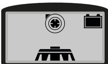
L'immagine qui a fianco identifica la schermata lavoro "LAVAGGIO CON ASCIUGATURA IN MODALITÀ ECO-MODE" versioni BT - BTO. Il simbolo che compare al centro dello schermo serve per identificare la tipologia di lavoro che si sta effettuando. In questo caso sia il corpo basamento che il corpo tergipavimento sono a contatto con il pavimento. Il programma di lavoro selezionato è quello eco-mode.
