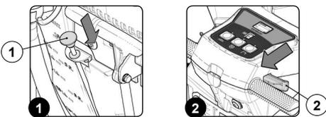
3. Durante i primi metri controllare che la quantità di soluzione sia sufficiente a bagnare il pavimento, ma non tanta da uscire dai paraspruzzi, la regolazione di fuoriuscita del detergente viene effettuata tramite il pomello (1) presente nella parte posteriore dell'apparecchio.
