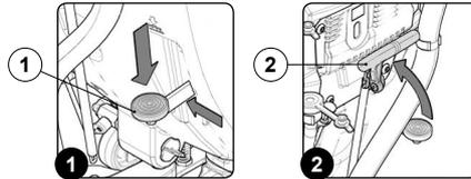
3. Portare l'apparecchio nel luogo adibito allo scarico delle acque sporche e provvedere a svuotare il serbatoio recupero (leggere il paragrafo "SVUOTAMENTO SERBATOIO RECUPERO" e "PULIZIA FILTRO-GALLEGGIANTE SERBATOIO RECUPERO").
