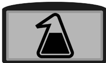
L'immagine qui a fianco identifica la "REGOLAZIONE PERCENTUALE DETERGENTE" nel circuito impianto idrico (versioni con sistema CDS). Il simbolo che compare al centro dello schermo serve per identificare che in quel momento si sta effettuando la regolazione della percentuale del detergente nel circuito impianto idrico dell'apparecchio.
