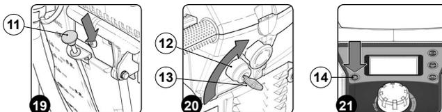
**NOTABENE:** Impostare al massimo la quantità di acqua presente nel sistema di dosaggio, premendo il pulsante (14) fino a che il simbolo "REGOLAZIONE QUANTITÀ ACQUA" sia completamente riempito (Fig.22).
