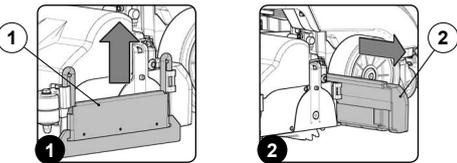
**i** **NOTABENE:** Per effettuare quest'operazione utilizzare la maniglia costampata posizionata nella parte inferiore del cassetto di raccolta.
