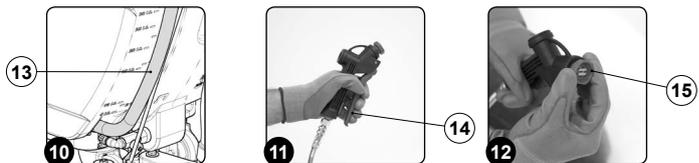
12. Pulire bene con un getto d'acqua e poi con un panno umido la camera di aspirazione del corpo del tergipavimento.
