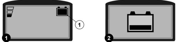
**NOTABENE:** Dopo alcuni secondi che la carica delle batterie arriva al 20%, il motore spazzola si spegne automaticamente. Con la carica residua è comunque possibile terminare il lavoro di asciugatura prima di procedere alla ricarica.
