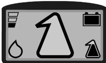
L'immagine qui a fianco identifica la "QUANTITÀ PERCENTUALE DETERGENTE A ZERO" nel circuito impianto idrico (versioni con sistema CDS). Il simbolo che compare al centro dello schermo serve per identificare che in quel momento la percentuale di detergente nell'impianto idrico dell'apparecchio è pari a zero.
