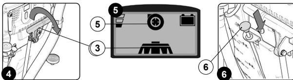
**(i) NOTABENE:** Traslato verso il basso il pomello regolazione flusso soluzione detergente, si aumenterà la quantità di soluzione all'interno dell'impianto idrico dell'apparecchio (Fig.6).
