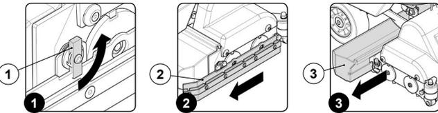
7. Pulire l'interno del cassetto di raccolta sotto un getto di acqua corrente, se necessario utilizzare una spatola per rimuovere residui di sporcizia.
