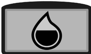
L'immagine qui a fianco identifica la "REGOLAZIONE LIVELLO QUANTITÀ ACQUA" nel circuito impianto idrico (versioni con sistema CDS). Il simbolo che compare al centro dello schermo serve per identificare che in quel momento si sta effettuando la regolazione della quantità di acqua nel circuito impianto idrico dell'apparecchio.
