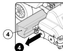
8. Svuotare il cassetto di raccolta sotto, se necessario utilizzare una spatola per rimuovere residui di sporcizia.
