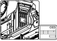
Das Kennschild mit Seriennummer befindet sich in der Maschine, auf der Verkleidung der Elektroanlage und enthält die allgemeinen Daten der Maschine, darunter insbesondere ihre Seriennummer. Die Seriennummer ist eine äußerst wichtige Information, die bei jeder Kundendienstanforderung oder Ersatzteilbestellung angegeben werden muss. Dem Typenschild sind die folgenden Angaben zu entnehmen:
