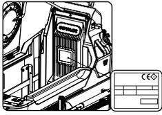
La placa de la matrícula se sitúa dentro de la máquina, sobre el cárter de cobertura del sistema eléctrico y contiene las características generales de la máquina, especialmente el número de serie de la misma. El número de serie es una información muy importante que se debe comunicar en cualquier pedido de asistencia o compra de piezas de repuesto. En la placa de la matrícula se pueden leer las siguientes indicaciones:
