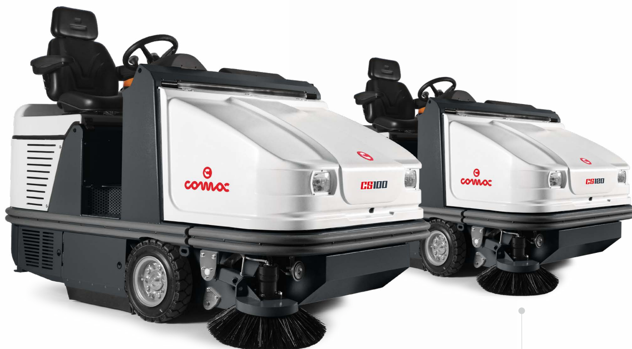
CS100 B/D Version mit einer oder zwei Seitenbürsten Zentralbürste: 1000 mm
