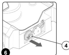
10. Colocar el tapón de descarga (4) en su posición, en la parte trasera del tanque.
