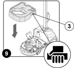
8. Colocar el tanque solución en la máquina, prestando atención a no dañar el tubo de aspiración de aire de entrada (6) del motor de aspiración y el tubo de aspiración del cuerpo de la boquilla de aspiración (7). Para colocar el tanque utilizar las manillas (3) del tanque solución (Fig.9 y Fig.10).
