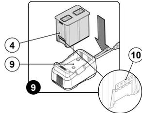
**⚠ ATENCIÓN:** La batería puede colocarse en el alimentador en un solo sentido. No forzar excesivamente al colocar la batería.
