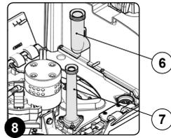
12. Posar el tanque de recuperación sobre el tanque solución, prestando atención a no dañar el tubo de aspiración de aire de entrada (6) del motor de aspiración y el tubo de aspiración del cuerpo de la boquilla de aspiración (7). Para colocar el tanque utilizar las manillas (3) del tanque solución (Fig.9 y Fig.10).
