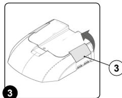
6. Quitar la tapa de aspiración utilizando las palancas de bloqueo. Posarlo con cuidado en el pavimento (Fig.4).
