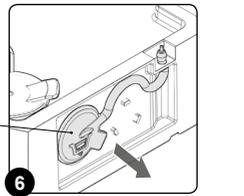
6. Colocar en su alojamiento situado en la parte trasera del tanque solución, el tapón de descarga (4) de la solución detergente (Fig.7).
