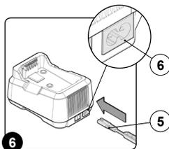
7. Conectar la clavija del cable del cargador de batería en la toma de alimentación.
