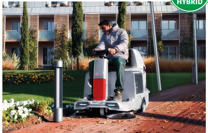
CS60 Hybrid arbeitet ununterbrochen bis zu 7,5 Stunden. Während die Kehrmaschine den Benzinmotor verwendet, werden die Batterien aufgeladen: Auf diese Weise ist der Wechsel von Benzin- auf Stromversorgung und damit ein leises, umweltfreundliches und kostenbewusstes Arbeiten möglich
