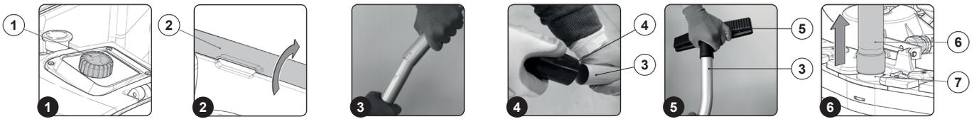
7. Collegare il tubo di aspirazione kit lancia aspira liquidi (4) con il tubo aspirazione tergipavimento (5) (Fig.7).
