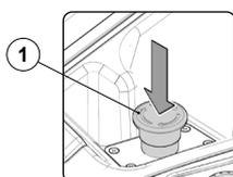
Si durante el trabajo surgieran graves problemas de seguridad, presionar el pulsador desconecta baterías (1) ubicado sobre el cárter que cubre la instalación eléctrica.
