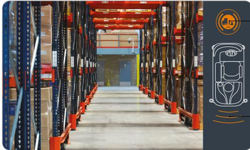
**i** **NOTA:** si la máquina posee cámara trasera, acoplando la marcha atrás se visualiza en la pantalla de mando la imagen de la cámara conectada y en el lado derecho de la pantalla se puede ver el perfil estilizado de la máquina.
