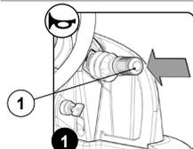
La máquina cuenta con un indicador acústico: ante la necesidad de emitir cualquier señal acústica basta con presionar el pulsador (1) de la palanca de mando de marcha (Fig. 1).
