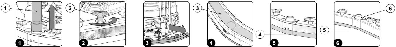
**i** **NOTA:** Controlar el estado de desgaste de la goma trasera (4) del cuerpo de la boquilla de aspiración: si la arista de la goma que está en contacto con el pavimento está deteriorada, proceder a su sustitución tal como se indica en el apartado ["SUSTITUCIÓN DE LAS GOMAS DEL CUERPO DE LA BOQUILLA DE ASPIRACIÓN"](#).
