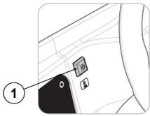
La máquina puede equiparse con luces cortesía para aumentar la visibilidad de las partes que podrían requerir controles por parte del operador, para activar estas luces, presionar el interruptor (1) en la columna de dirección (Fig.1).
