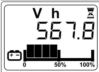
En el panel de control se encuentra la pantalla de mandos, la segunda página después del encendido permite observar el tiempo total de uso de la máquina.
