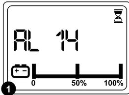
En las versiones essential, cuando se produce un error, en la pantalla de mando se visualizará la leyenda AL seguida por un número (Fig.1), que solo desaparece cuando se resuelve el error.
