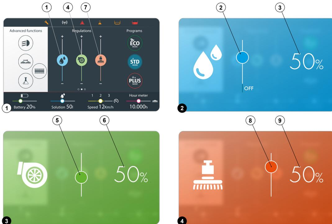
Si durante el trabajo se necesita modificar el flujo de solución detergente en los cepillos, presionar en el símbolo (1) de la pantalla de mando (Fig.1).
