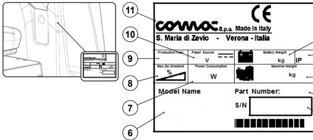
1. El valor indicado en Kg del peso de las baterías de alimentación de la máquina.
