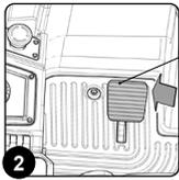
**! PRUDENCIA:** el freno eléctrico de la máquina cumple solo la función de freno de estacionamiento.
