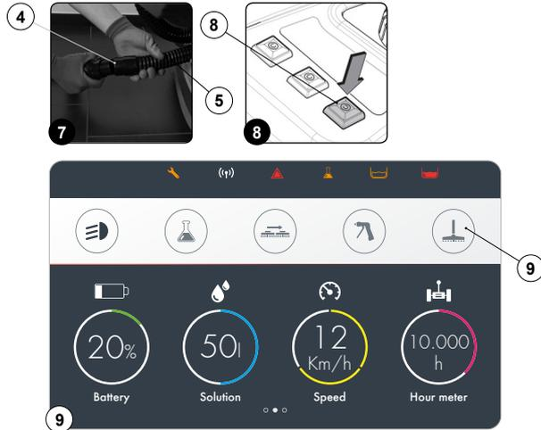
**i** **NOTA:** apenas se presiona el interruptor (8) o el pulsador (9) se accionará el motor aspiración y se podrá efectuar el trabajo de secado.
