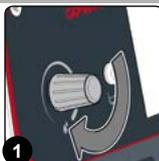
Wenn der Durchsatz der Reinigungslösung auf die Bürsten während der Arbeit geändert werden muss, reicht es den Knauf an der Bedientafel zu drehen (**Abb. 1**).
