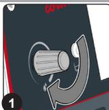
Se durante il lavoro si ha la necessità di modificare il flusso di erogazione della soluzione detergente sulle spazzole basta agire sul pomello presente nel pannello di controllo (Fig.1).
