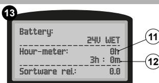
Mediante la pantalla de control, en la tercera página después del encendido, se pueden ver en la parte central (Fig. 13), las horas de trabajo de la máquina.
