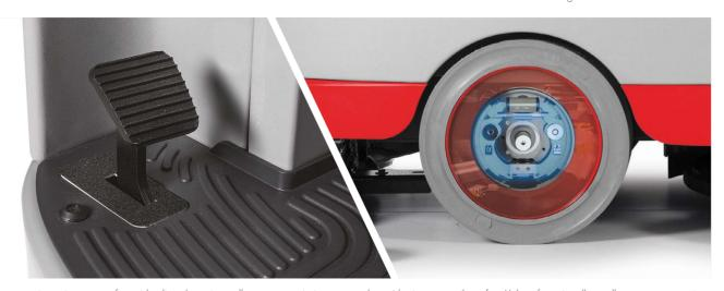
Optima è stata equipaggiata con un freno idraulico che agisce sulle ruote posteriori, aumentando così la sicurezza e il comfort. L'elettrofreno installato sulla motoruota anteriore funge da freno di emergenza o di parcheggio.
