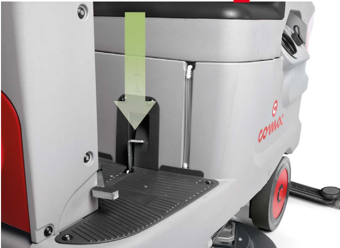
Pedaldruckerhöhung (Für automatische Zweibürstenmodelle).
