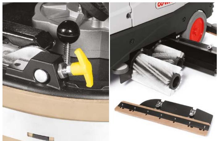
Las partes implicadas en el mantenimiento diario son de color amarillo para facilitar su identificación. El sistema de desenganche de los cepillos ha sido diseñado para facilitar enormemente esta operación.
