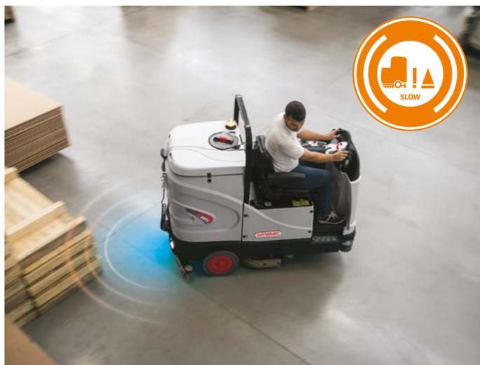
Para aumentar aún más la seguridad, se puede instalar el sensor anticollision en la parte trasera de la máquina. La detección de posibles obstáculos es una ayuda excelente para la prevención de accidentes durante el uso.
