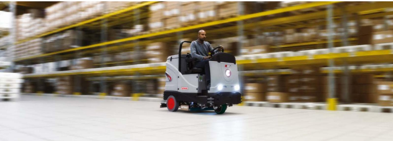
Operaciones de limpieza rápidas para optimizar el tiempo: hasta 8 km/h durante el trabajo. Un sensor continuo situado en el eje de dirección reconoce la posición exacta de la rueda de tracción delantera y reduce automáticamente la velocidad de la máquina según sea necesario. El sensor permite que la máquina avance suavemente y sin vacíos. Un riguroso estudio ergonómico ha permitido
