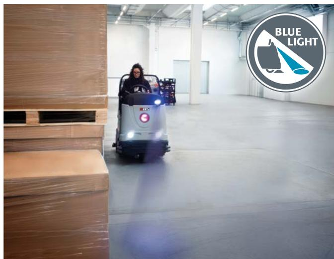
C75, C85 y C100 pueden ser equipadas con **Blue Safety Spotlight**, la tecnología que proyecta un haz de luz sobre el suelo para señalar con antelación la presencia de la fregadora de pavimentos y aumentar así la seguridad.
