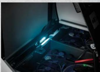
La gama C puede equiparse con un paquete de luces LED de cortesía para aumentar la visibilidad de aquellas partes donde el operador podría tener que realizar operaciones de mantenimiento.
