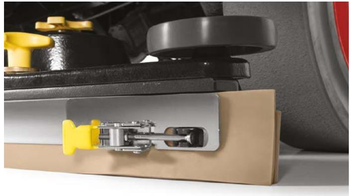
La gama C está equipada de serie con gomas de la boquilla de aspiración y parasalpicaduras de 40 shore, que tienen una vida útil más larga y un mejor rendimiento en suelos con juntas. Las dos se pueden utilizar por los 4 lados y, para simplificar aún más las operaciones de mantenimiento, el nuevo sistema de fijación de acero inoxidable permite cambiar las hojas de la boquilla de aspiración y los parasalpicaduras sin necesidad de utilizar herramientas.
