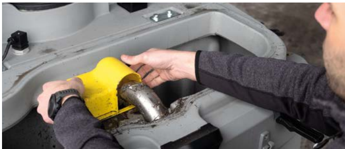
Filtro a cestello per bloccare eventuali detriti ed evitare che si depositino sul fondo del serbatoio di recupero.
