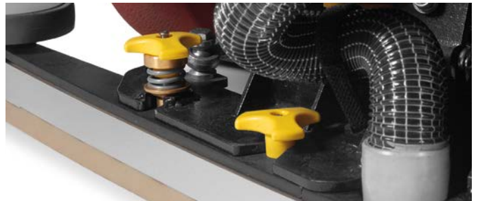
Von der täglichen Wartung betroffene Teile sind gelb gekennzeichnet, um sie leichter erkennen zu können.
