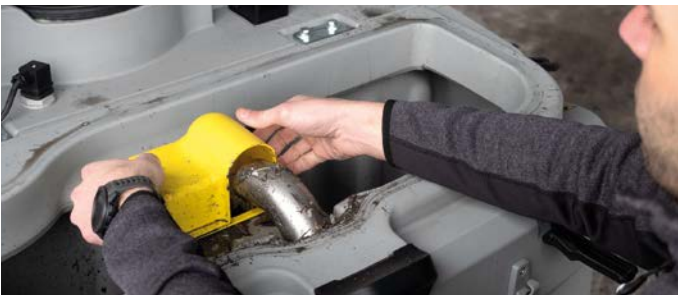
Korbfilter zum Auffangen eventueller Feststoffe und, um zu vermeiden, dass sie sich am Boden des Schmutzwassertanks absetzen.
