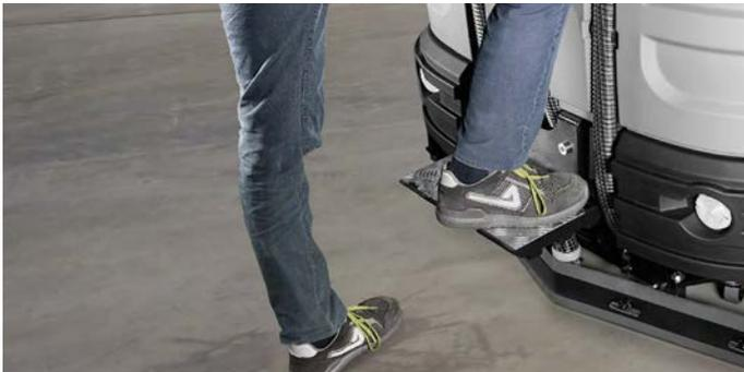
C130 è inoltre dotata di alcuni piccoli accorgimenti che facilitano l'operatore a svolgere la manutenzione quotidiana, come la comoda pedana posizionata nella parte posteriore della macchina che consente all'operatore di ispezionare con facilità i serbatoi e i sistemi di filtraggio della lavasciuga.
