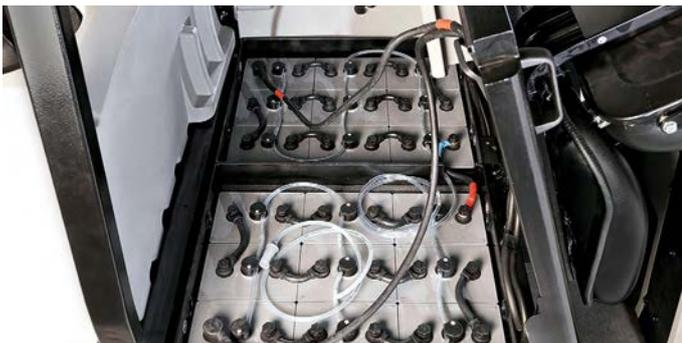
Rabbocco automatico delle batterie, che grazie ad un unico circuito collega tutti gli elementi e consente di regolare il livello di riempimento da un solo punto. Il rabbocco risulta quindi molto più veloce in quanto si riducono notevolmente le soste, e più sicuro, poiché si evitano fuoriuscite di elettrolita dalle batterie.
