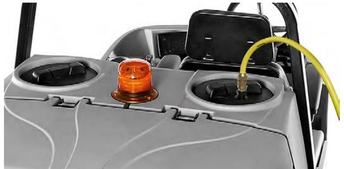
FFS – Fast Filling System, la tecnologia optional di Comac che consente di riempire il serbatoio dell'acqua con un apposito dispositivo, questa operazione non necessita della presenza dell'operatore e contribuisce quindi a ridurre i tempi morti della macchina.
