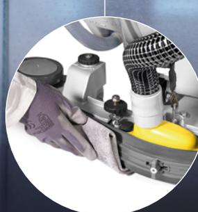
Para obtener un secado siempre perfecto es fundamental limpiar después de cada operación el tubo de aspiración y las gomas de la boquilla de aspiración. La boquilla se puede elevar para poder acceder fácilmente a las gomas y limpiar con rapidez.
