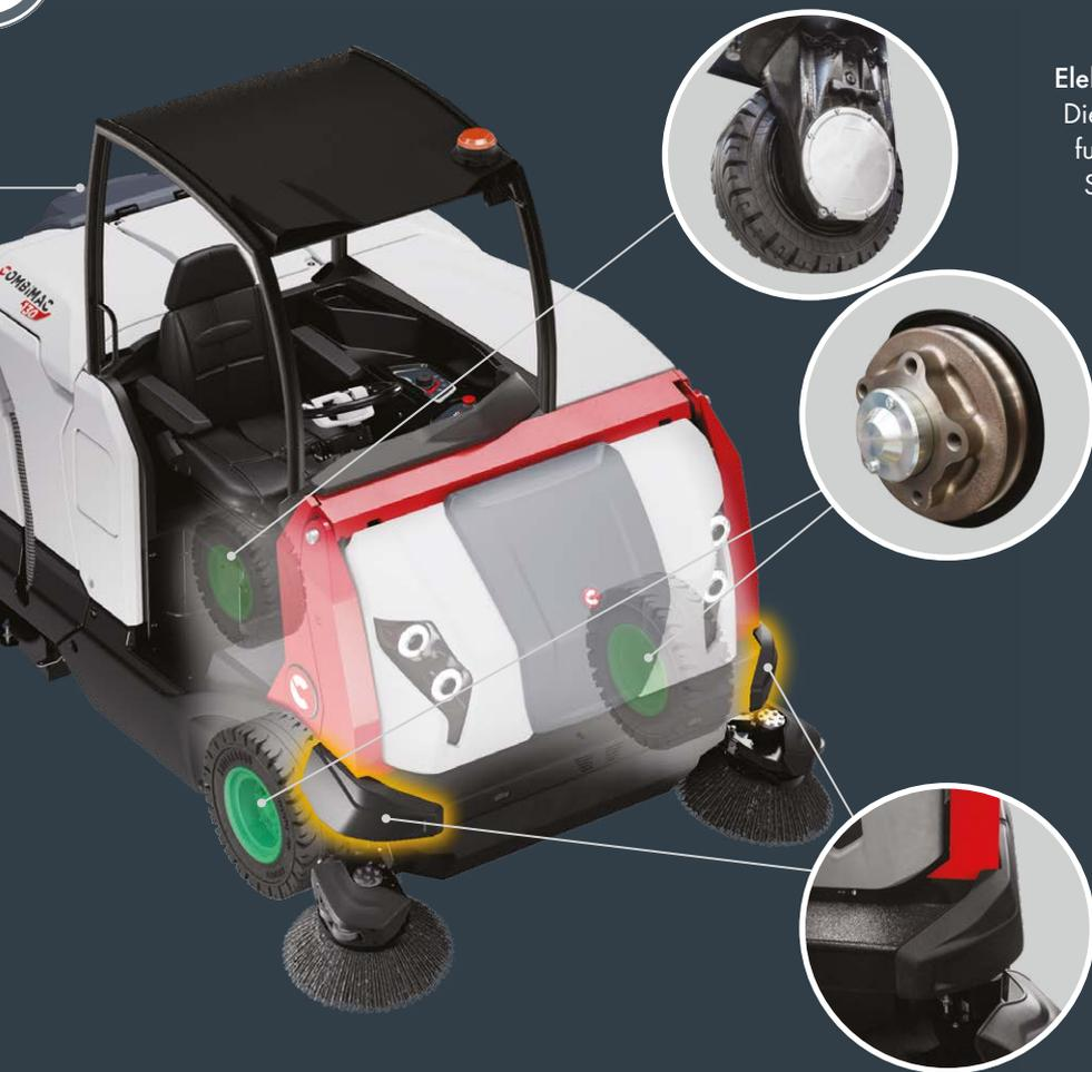
**Elektrobremsen und Trommelbremsen.**
