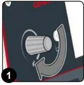
Si durante el trabajo se necesita modificar el flujo de solución detergente en los cepillos, utilizar el pomo situado en el panel de control (Fig.1).
