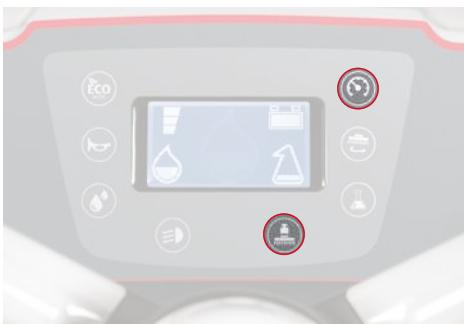
Il est possible de sélectionner l'une des 3 vitesses de travail et niveaux de pression des brosses afin d'adapter la machine à n'importe quelle condition.
