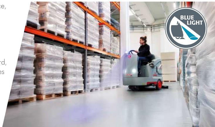
Optima peut-être équipée du **Blue Safety Spotlight** la technologie qui projette un faisceau de lumière sur le sol pour signaler à l'avance la présence de l'autolaveuse, augmentant ainsi la sécurité.
