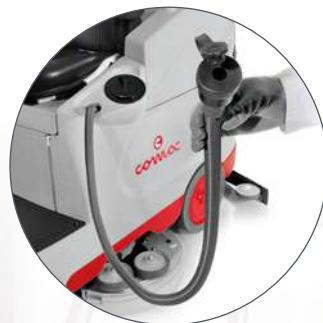
Le tube de remplissage du réservoir de solution est pratique et d'une longueur adaptée à atteindre directement le robinet d'eau. A la place, il est possible d'utiliser un système de remplissage rapide avec flotteur afin de réduire au minimum les délais d'immobilisation de la machine.
