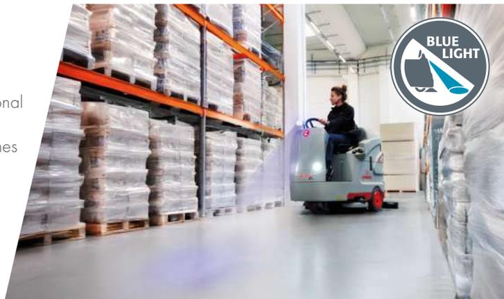
Optima puede equiparse con **Blue Safety Spotlight**, la tecnología que proyecta un haz de luz sobre el suelo para señalar con antelación la presencia de la fregadora de pavimentos y aumentar así la seguridad
