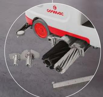
En la versión fregadora-barridora Optima 90 BS, la sustitución de los cepillos no requiere herramientas y se realiza en pocos segundos.
