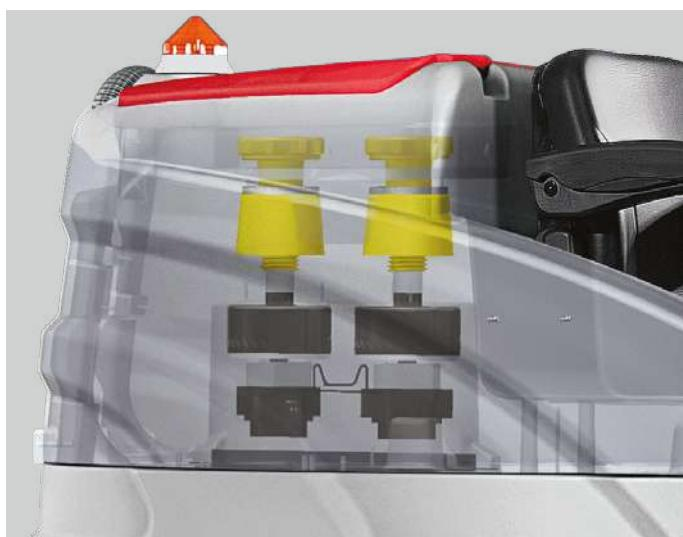
Per ottenere il massimo dell'efficacia, Optima può essere dotata del Kit Rampe che permette di aumentare l'aderenza della ruota anteriore migliorando la fase di salita di eventuali rampe. Grazie al peso supplementare il carico verrà distribuito in maniera da evitare eventuali slittamenti.
