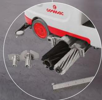
Bei der Schrubbe-Kehrausführung der Optima 90 S ist der Bürstenwechsel in wenigen Sekunden erledigt, da kein Werkzeug benötigt wird.
