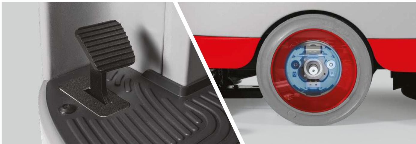
Optima wurde mit einer hydraulischen Bremse ausgestattet, die auf die Hinterräder wirkt und somit Sicherheit und Komfort erhöht. Die elektrische Bremse am Vorderradantrieb wirkt als Not- oder Feststellbremse.
