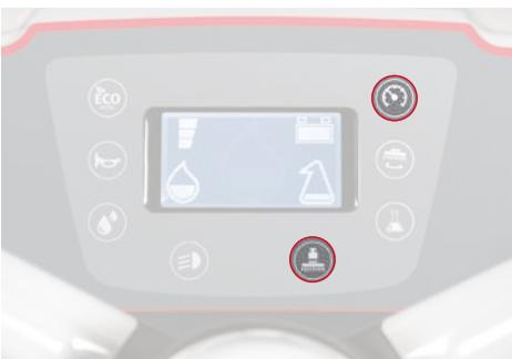
Zum Anpassen der Maschine an alle möglichen Bedingungen kann der Bediener aus 3 verschiedenen Arbeitsgeschwindigkeiten und Bürstdruckstufen wählen.
