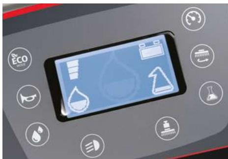
Bei den Ausführungen mit CDS-Dosiervorrichtung lassen sich die Wassermenge und der Prozentsatz an Reinigungsmittel einstellen und speichern, damit sie beim nächsten Gebrauch automatisch aktiviert werden können.
