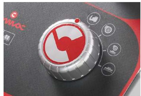
Über den Arbeitsprogrammwahlschalter lassen sich die Einstellungen der Maschine auswählen, wie: Überstellen, Trocknen, Schrubben und Trocknen zusammen und nur Schrubben.
