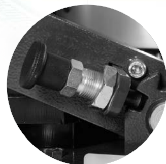
Desenganche rápido de la bancada del motor del carro y del peso de 17 kg, y desconexión del sistema eléctrico.
