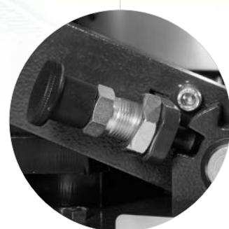
Décrochage rapide du carter moteur du chariot et du poids de 17 kg et débranchement du système électrique.
