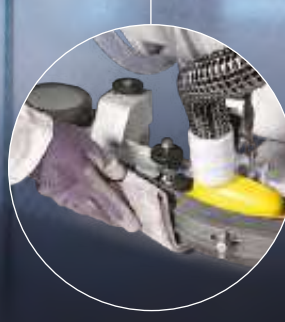
Pour assurer un séchage toujours impeccable du sol, il est essentiel de nettoyer le tuyau d'aspiration et les brosses du suceur à la fin de chaque cycle de travail. Le suceur peut être soulevé pour pouvoir accéder aisément aux brosses et les nettoyer rapidement.
