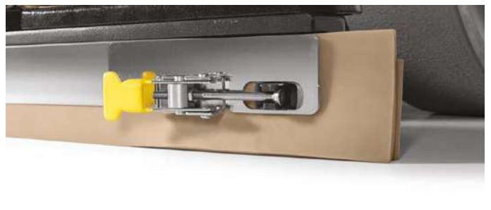
Neues Befestigungssystem aus Edelstahl am Saugfuß, um den Austausch der Saugfußgummis und der Spritzschutzleisten ohne Werkzeug zu ermöglichen.
