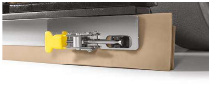
Nuovo sistema di fissaggio in acciaio inossidabile posto sul tergilavaggio per permettere la sostituzione delle gomme tergi e dei paraspruzzi senza l'utilizzo di attrezzi.
