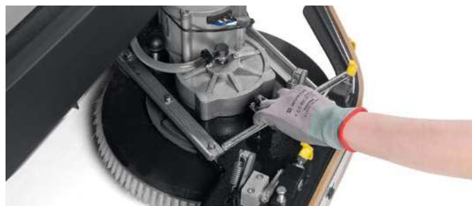
Basamento estraibile sul lato sinistro per facilitare l'ispezione e la sostituzione della spazzola a disco centrale.
