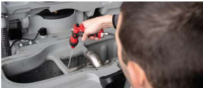
Spray Tool per nebulizzare la soluzione sulle superfici non raggiungibili con la lavasciuga e per pulire i serbatoi in modo semplice ed efficace.
