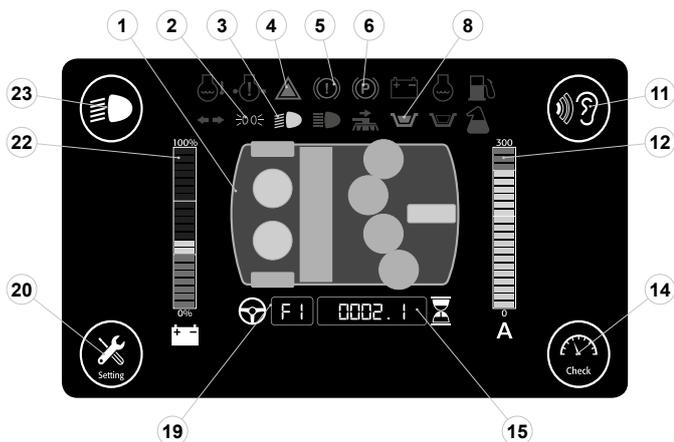
Al seleccionar el programa "SECADO", la página de la pantalla de control se visualizará como en la figura aquí representada. Todas las bancadas están levantadas del pavimento y no están en funcionamiento, mientras que el cuerpo de la boquilla de aspiración se encuentra en posición de trabajo y ambos motores aspiración están activos.
