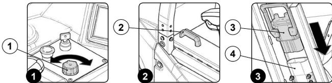
6. Sujetar la manilla (2) y bajar la plancha de soporte del asiento a la posición de trabajo (Fig. 4).
