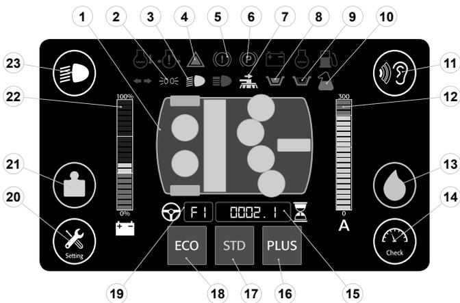
Al seleccionar el programa "LAVADO CON SECADO", la página de la pantalla de control se visualizará como en la figura aquí representada. Tanto el cuerpo de la boquilla de aspiración como todas las bancadas están en contacto con el pavimento.
