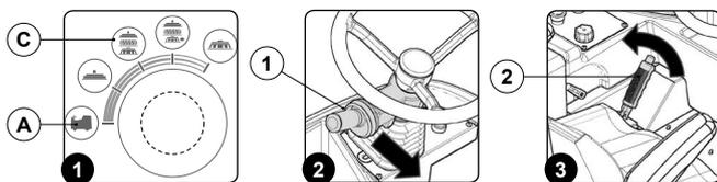
5. Seleccionar el programa i-drive "Lavado y secado" girando la empuñadura a la posición "C", tal como se indica en la (Fig. 1).
