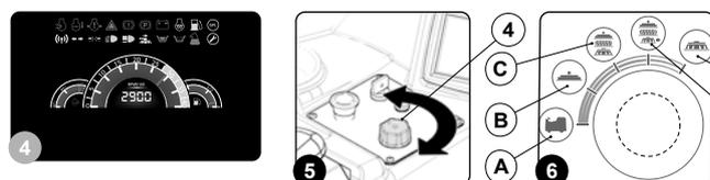
7. Aprire il passaggio della soluzione detergente nell'impianto idrico della macchina, ruotare la leva comando rubinetto (5) secondo il senso indicato dalla freccia (Fig.7).
