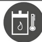
Si durante el trabajo, en el salpicadero se enciende el testigo luminoso rojo que se representa al lado, significa que se ha producido una anomalía en el funcionamiento del alternador (versión diesel). Suspender la tarea que se estaba realizando, llevar la máquina al lugar específico de mantenimiento y avisar al servicio de asistencia.
