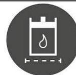
Si durante el trabajo, en el salpicadero se enciende el testigo luminoso rojo que se representa al lado, significa que el aceite de la instalación oleodinámica ha alcanzado una temperatura crítica. Suspender la tarea que se estaba realizando, llevar la máquina al lugar específico de mantenimiento y avisar al servicio de asistencia.
