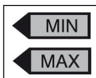
Símbolo nivel del líquido refrigerante del motor de combustión (versión diesel)
