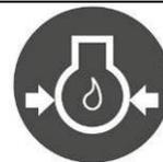
Si durante el trabajo, en el salpicadero se enciende el testigo luminoso amarillo del visor del nivel del combustible, significa que el nivel del combustible diesel ha alcanzado la zona de reserva del depósito (versión diesel). Suspender la tarea que se estaba realizando, llevar la máquina al lugar específico de mantenimiento y llenar el depósito del combustible siguiendo las instrucciones presentes en el capítulo "RELLENADO DEL DEPÓSITO DE COMBUSTIBLE (VERSIÓN DIESEL)"
