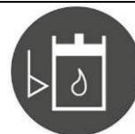
Si durante el trabajo, en el salpicadero se enciende el testigo luminoso rojo que se representa al lado, significa que el filtro del aceite de la instalación oleodinámica está obstruido. Suspender la tarea que se estaba realizando, llevar la máquina al lugar específico de mantenimiento y avisar al servicio de asistencia.
