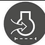
Si durante el trabajo, en el salpicadero se enciende el testigo luminoso rojo que se representa al lado, significa que se ha producido una anomalía en la presión del aceite del motor de combustión (versión diesel). Suspender la tarea que se estaba realizando, llevar la máquina al lugar específico de mantenimiento y avisar al servicio de asistencia.
