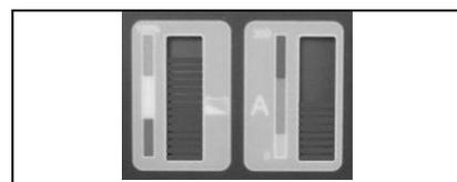
Falls während des Maschineneinsatzes die nebenstehend abgebildete rote Kontrollleuchte am Instrumentenbrett aufleuchtet, weist dies darauf hin, dass der Ölpegel der Bremsanlage niedrig ist, die laufende Arbeit muss beendet, die Maschine an ihren Wartungsplatz verbracht und der Kundendienst verständigt werden.
