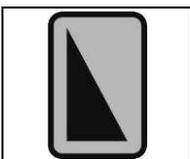
Symbol für die Einstellung der Arbeitsgeschwindigkeit (Diesel - Bifuel-Ausführung)
