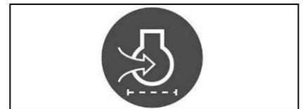
Falls während des Maschineneinsatzes die nebenstehend abgebildete rote Kontrollleuchte am Instrumentenbrett aufleuchtet, weist dies auf eine Störung beim Öldruck des endothermischen Motors (Dieselausführung) hin, die laufende Arbeit muss beendet, die Maschine an ihren Wartungsplatz verbracht und der Kundendienst verständigt werden.
