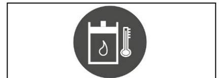
Falls während des Maschineneinsatzes die nebenstehend abgebildete rote Kontrollleuchte aufleuchtet, weist dies darauf hin, dass beim Wechselstromgenerator eine Betriebsstörung aufgetreten ist (Dieselausführung), die laufende Arbeit muss beendet, die Maschine an ihren Wartungsplatz verbracht und der Kundendienst verständigt werden.
