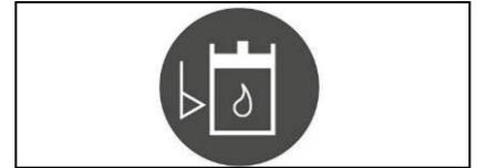
Falls während des Maschineneinsatzes die nebenstehend abgebildete rote Kontrollleuchte am Instrumentenbrett aufleuchtet, weist dies darauf hin, dass der Filter der Ölhydraulikanlage verstopft ist, die laufende Arbeit muss abgebrochen, die Maschine an ihren Wartungsplatz verbracht und der Kundendienst verständigt werden.
