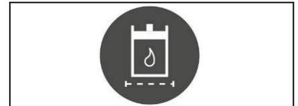
Falls während des Maschineneinsatzes die nebenstehend abgebildete rote Kontrollleuchte aufleuchtet, weist dies darauf hin, dass das Öl der Ölhydraulikanlage eine kritische Temperatur erreicht hat, die laufende Arbeit muss abgebrochen, die Maschine an ihren Wartungsplatz verbracht und der Kundendienst verständigt werden.
