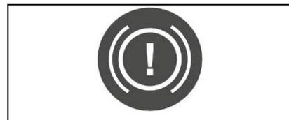
Si durante el trabajo, en el salpicadero se enciende el testigo luminoso rojo (versiones batería - versión diesel) y verde (versión Bifuel) que se representa al lado, significa que el nivel del aceite de la instalación oleodinámica es "escaso". Suspender la tarea que se estaba realizando, llevar la máquina al lugar específico de mantenimiento y avisar al servicio de asistencia.
