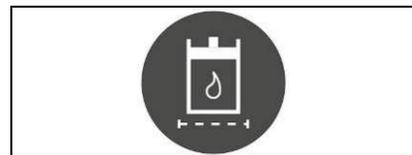
Si durante el trabajo, en el salpicadero se enciende el testigo luminoso rojo (versiones batería - versión diesel) y verde (versión Bifuel) que se representa al lado, significa que el aceite de la instalación oleodinámica alcanzó una temperatura crítica. Suspender la tarea que se estaba realizando, llevar la máquina al lugar específico de mantenimiento y avisar al servicio de asistencia.
