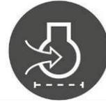
Si durante el trabajo, en el salpicadero se enciende el testigo luminoso rojo que se representa al lado, significa que se ha producido una anomalía en la presión del aceite del motor de combustión (versión diesel). Suspender la tarea que se estaba realizando, llevar la máquina al lugar específico de mantenimiento y avisar al servicio de asistencia.
