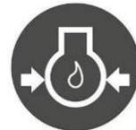
Si durante el trabajo, en el salpicadero se enciende el testigo luminoso amarillo del visor del nivel del combustible, significa que el nivel del combustible diesel ha alcanzado la zona de reserva del depósito (versión diesel). Suspender la tarea que se estaba realizando, llevar la máquina al lugar específico de mantenimiento y llenar el depósito del combustible siguiendo las instrucciones presentes en el capítulo "RELLENADO DEL DEPÓSITO DE COMBUSTIBLE (VERSIÓN DIESEL)"
