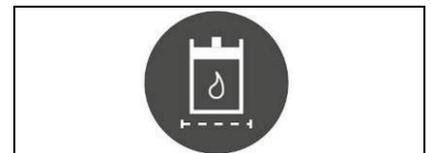
Falls während des Maschineneinsatzes die nebenstehend abgebildete rote Kontrollleuchte (Batterie-/Dieselausführung) und die grüne Kontrollleuchte (Bifuel-Ausführung) am Instrumentenbrett aufleuchtet, weist dies darauf hin, dass die Öltemperatur der Ölhydraulikanlage einen kritischen Wert erreicht hat und somit die laufende Arbeit beendet, die Maschine an ihren Wartungsplatz verbracht und der Kundendienst verständigt werden muss.
