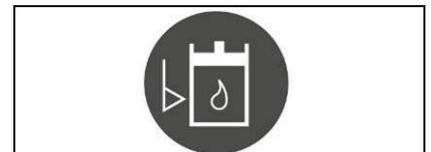
Falls während des Maschineneinsatzes die nebenstehend abgebildete rote Kontrollleuchte (Batterie-/Dieselausführung) und die grüne Kontrollleuchte (Bifuel-Ausführung) am Instrumentenbrett aufleuchtet, weist dies darauf hin, dass der Ölfilter der Ölhydraulikanlage verstopft ist und somit die laufende Arbeit beendet, die Maschine an ihren Wartungsplatz verbracht und der Kundendienst verständigt werden muss.
