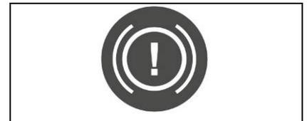
Falls während des Maschineneinsatzes die nebenstehend abgebildete rote Kontrollleuchte (Batterie-/Dieselausführung) und die grüne Kontrollleuchte (Bifuel-Ausführung) am Instrumentenbrett aufleuchtet, weist dies darauf hin, dass der Ölstand der Ölhydraulikanlage "niedrig" ist und somit die laufende Arbeit beendet, die Maschine an ihren Wartungsplatz verbracht und der Kundendienst verständigt werden muss.
