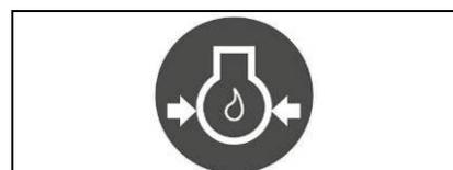
Falls während des Maschineneinsatzes das Kraftstoffpegel-Display einen kritischen Bereich erreicht, schaltet sich am Instrumentenbrett die gelbe Kontrollleuchte ein, die anzeigt, dass der Reservebereich des Tanks erreicht ist (Dieselausführung) die laufende Arbeit muss beendet, die Maschine an ihren Wartungsplatz verbracht und der Tank befüllt werden. Beachten Sie dazu die Anweisungen im Kapitel "BEFÜLLUNG DES KRAFTSTOFFTANKS (DIESELAUSFÜHRUNG)"
