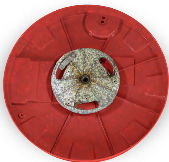
SENZA TRATTAMENTO CORROSION PROTECTION
