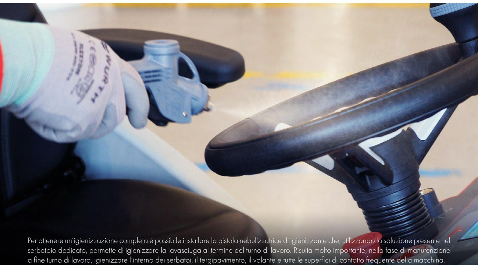
Per ottenere un'igienizzazione completa è possibile installare la pistola nebulizzatrice di igienizzante che, utilizzando la soluzione presente nel serbatoio dedicato, permette di igienizzare la lavasciuga al termine del turno di lavoro. Risulta molto importante, nella fase di manutenzione a fine turno di lavoro, igienizzare l'interno dei serbatoi, il tergipavimento, il volante e tutte le superfici di contatto frequente della macchina.
