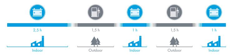
HYBRID ERLAUBT DEN WECHSEL ZWISCHEN DEN VERSCHIEDENEN ANTRIEBEN UND ERMÖGLICHT SO BIS ZU 7,5 ARBEITSSTUNDEN OHNE UNTERBRECHUNG (CS60). DIE BATTERIEN WERDEN AUTOMATISCH WIEDER AUFGELADEN, WÄHREND DER BENZINMOTOR IN BETRIEB IST.
